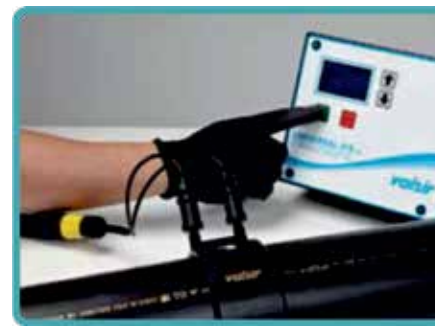
Sudură cu mufă electrosudabilă, diametrul 40÷315 mm.
